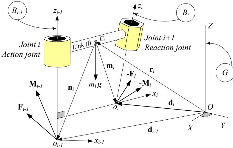
FIGURE 12.2. Force system on link ( $i$ ).
