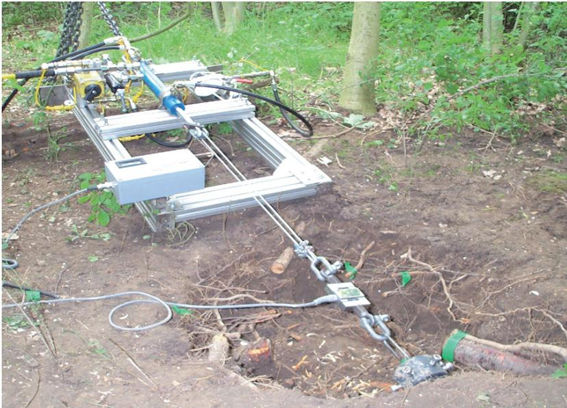
Figure 5-7. Root pull out apparatus (Photo: J.E. Norris).
