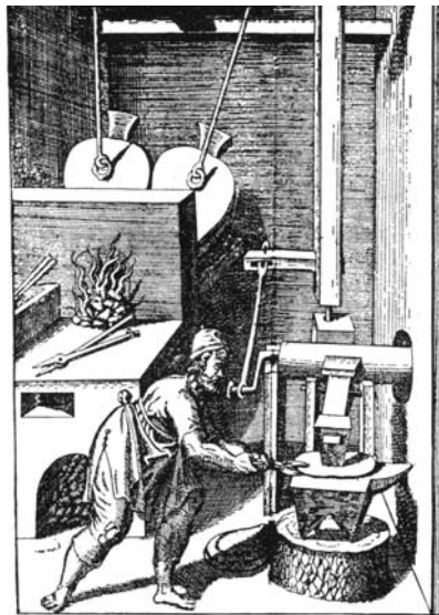
Fig. 2.1 Applicazione di una ruota idraulica alimentata per di sotto da un ruscello per la follatura dei tessuti (sopra) e per azionare due mantici e un maglio in una forgia (sotto) nella descrizione di Jacopo de Strada (1507-1588).
