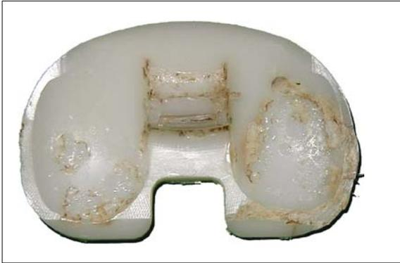
**Fig. 3.** Espianto di inserto sterilizzato a raggi gamma. Si notino i gravi danni di delaminazione causati dall'ossidazione
