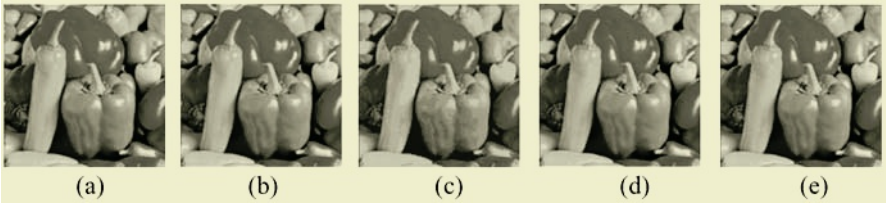
Fig. 3. Reconstructed Peppers Images. (a) DCSMPVQ T=400 ; (b) FSMPVQ T=300 ; (c) MSVQ; (d) MSPVQ; (e) MPDWBPVQ
