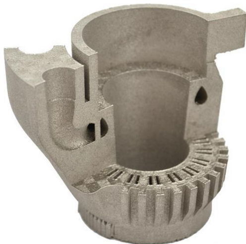
Fig. 22 Section of a Nozzle made by SLM (Courtesy of VisiConsult X-ray Systems & Solutions GmbH and IFW - Günter-Köhler-Institut für Fügetechnik und Werkstoffprüfung GmbH)
